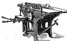
Abrichtbreite: 500 od. 600 mm
