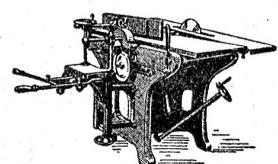
Abrichtbreite: 500 od. 600 mm
