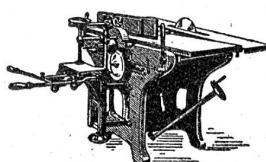
Abrichtbreite: 500 od. 600 mm
