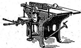
Abrichtbreite: 500 od. 600 mm
