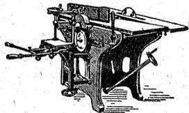
Abrichtbreite: 500 od. 600 mm
