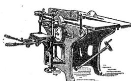
Abrichtbreite: 500 od. 600 mm
