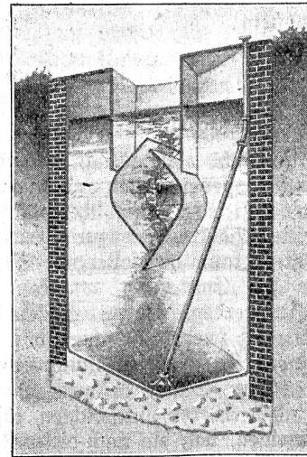
eigneter Mittel läßt sich die Bakterientätigkeit und damit die Aufzehrung der organischen Bestandteile sogar fast bis zur vollständigen Mineralisierung des Schlammes steigern. Dabei entweicht ein Teil der organischen Substanz in Gasform, was von ganz besonderer Wichtigkeit ist, wenn Gasgewinnung in Frage kommt.
