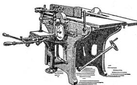
Abrichtbreite: 500 od. 600 mm
