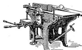
Abrichtbreite: 500 od. 600 mm
