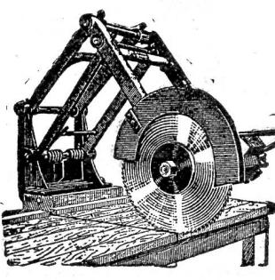
mit eingebautem 2 PS Spez. Elektromotor (jede Stromart) schneidet genau parallel zum Tischblatt in einer Breite von 80 cm.
