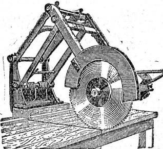
mit eingebautem 2 PS Spez. Elektromotor (jede Stromart) schneidet genau parallel zum Tischblatt in einer Breite von 80 cm.
