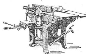
Abrichtbreite: 500 od. 600 mm
