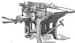
Abrichtbreite: 500 od. 600 mm
