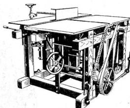
Abrichtbreite: 550 mm
