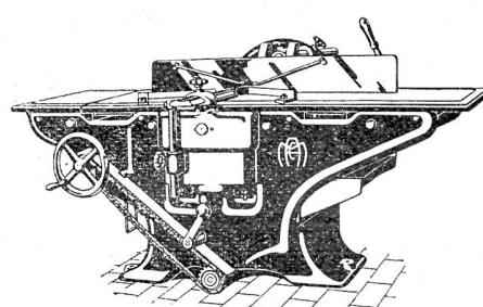
Kombinierte Abricht-, Kehl- und Dickenhobelmaschine 36b
