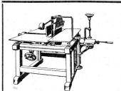
Komb. Abricht- u. Dickehobel-, Fräs- und Bohrmaschine
