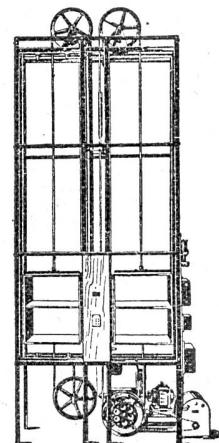
Speise- und Aktenaufzüge elektrisch od. für Handbetrieb äusserst leichter und geräuschloser Gang Warenaufzüge bewährter Systeme
