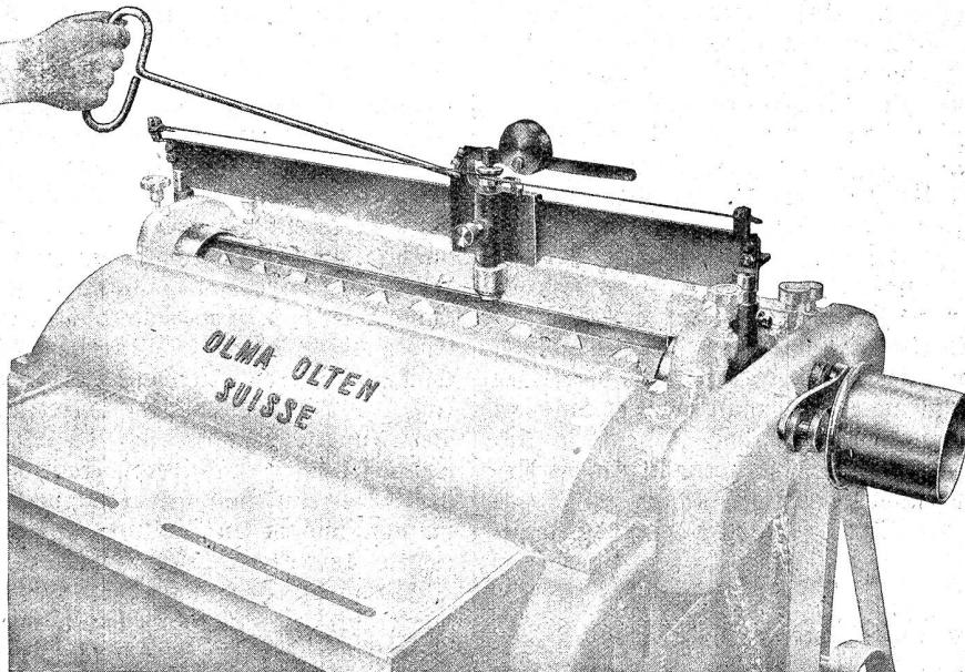
wiesen, es sind Vorschubgeschwindigkeiten bis 18 m per Minute zulässig. Der Vorschub geschieht durch Frictionsgetriebe und ist während des Ganges der Maschine veränderlich, welche Bauart in vier Staaten patentiert ist, darunter auch in Deutschland.
