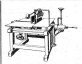
Komb. Abricht- u. Dickehobel-, Fräs- und Bohrmaschine
