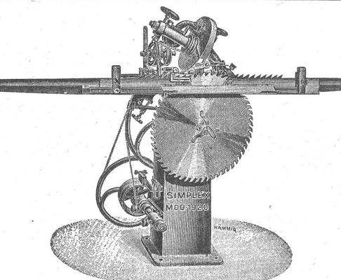
Obige 2 automatischen Sägenschärfmaschinen sind zum Schärfen von Gattersägen, Bandsägen und Fräsen konstruiert. Unerreichbar in Solidität und Leistungsfähigkeit. Modell 1920 ist noch extra zum Schärfen enger Zahnnungen wie Bandsägen und kleiner Fräsen in Schreinereien sowie für Eisenfräsen in mech. Werkstätten konstruiert. Unterzeichneter liefert auch **Schmirgelscheiben**, nur beste Sorten, sowie **Leder- und Baumwollsaiten**, beste Qualität
