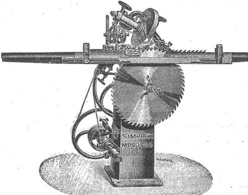
Obige 2 automatischen Sägenschärfmaschinen sind zum Schärfen von Gattersägen, Bandsägen und Fräsen konstruiert. Unerreichbar in Solidität und Leistungsfähigkeit. Modell 1920 ist noch extra zum Schärfen enger Zahnnungen wie Bandsägen und kleiner Fräsen in Schreinereien sowie für Eisenfräsen in mech. Werkstätten konstruiert. 868
