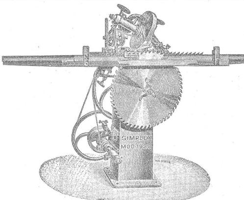
Obige 2 automatischen Sägenschärfmaschinen sind zum Schärfen von Gattersägen, Bandsägen und Fräsen konstruiert. Unerreichbar in Solidität und Leistungsfähigkeit. Modell 1920 ist noch extra zum Schärfen enger Zahnnungen wie Bandsägen und kleiner Fräsen in Schreinereien sowie für Eisenfräsen in mech. Werkstätten konstruiert.
