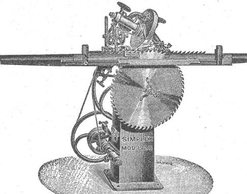
Obige 2 automatischen Sägenschärfmaschinen sind zum Schärfen von Gattersägen, Bandsägen und Fräsen konstruiert. Unerreichbar in Solidität und Leistungsfähigkeit. Modell 1920 ist noch extra zum Schärfen enger Zahnnungen wie Bandsägen und kleiner Fräsen in Schreinereien sowie für Eisenfräsen in mech. Werkstätten konstruiert.
