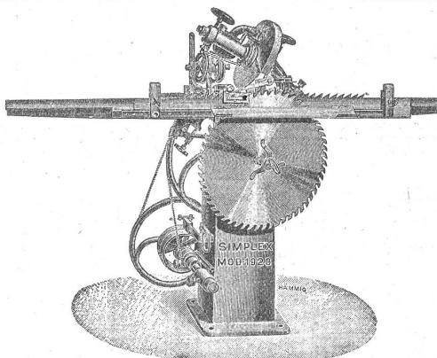
Obige 2 automatischen Sägenschärfmaschinen sind zum Schärfen von Gattersägen, Bandsägen und Fräsen konstruiert. Unerreichbar in Solidität und Leistungsfähigkeit. Modell 1920 ist noch extra zum Schärfen enger Zahnungen wie Bandsägen und kleiner Fräsen in Schreinereien sowie für Eisenfräsen in mech. Werksätzen konstruiert.
