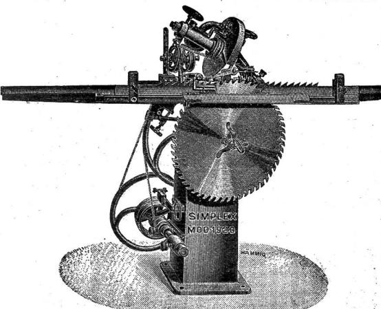
Obige 2 automatischen Sägenschärfmaschinen sind zum Schärfen von Gattersägen, Bandsägen und Fräsen konstruiert. Unerreichbar in Solidität und Leistungsfähigkeit. Modell 1920 ist noch extra zum Schärfen enger Zahnungen wie Bandsägen und kleiner Fräsen
