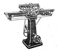
Automatische Hobelmesserschleifmaschine Modell MS
