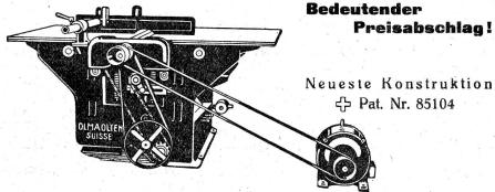
Komb. Abricht-Dickenhobelmaschinen mit 460 bis 610 mm Hobelbreite.
