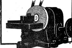
Die nachschleifbare Feile des modernen Fabrikbetriebes
