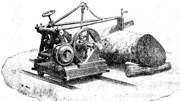
in den Handel gebracht worden, die obiges Resultat ganz wesentlich zu Gunsten der Maschinendarbeit einstellt. Die neue Maschine ist auch eine Fuchsschwanz-Maschinensäge für Rundholz bis 1 m Ø, ist aber durch ein neues Prinzip gelöst, das eine wesentliche Krafters-
