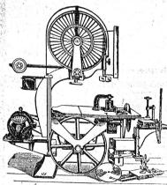
65, 70:80 cm Rollendurchmesser mit angebautem Elektromotor. 192
