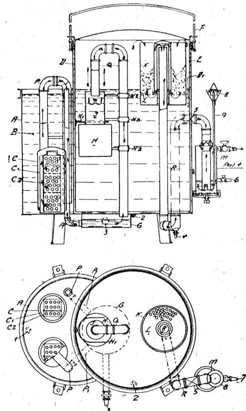
dort eine zweite Karbidabteilung überschwemmt. Von der Gasglocke hat das Gas einen weiteren Durchgang nur durch die Reinigungsmasse des chemischen Reinigers. Der direkte Durchgang, um die Reinigungsmasse herum, wird durch den Wasserverschluß verhindert. Vom Reiniger gelangt das Gas in die Wasser vorlage und durch Hahn 7 zur Verwendungstelle.
