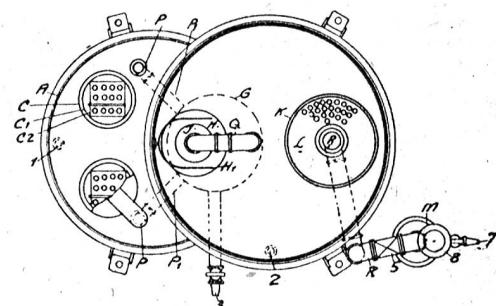
dort eine zweite Karbidabteilung überschwemmt. Von der Gasglocke hat das Gas einen weiteren Durchgang nur durch die Reinigungsmasse des chemischen Reinigers. Der direkte Durchgang, um die Reinigungsmasse herum, wird durch den Wasserverschluß verhindert. Vom Reiniger gelangt das Gas in die Wasser vorlage und durch Hahn 7 zur Verwendungstelle.
