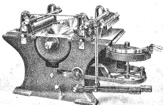
Doppelte Besäum- und Lattenkreissäge
