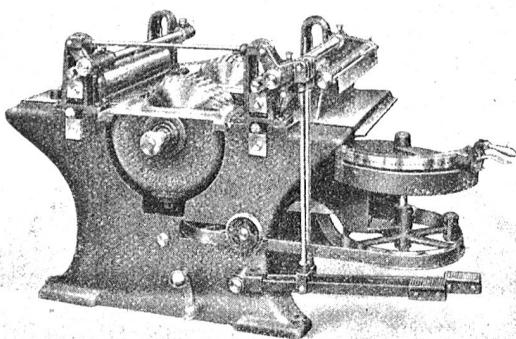
Doppelte Besäum- und Lattenkreissäge
