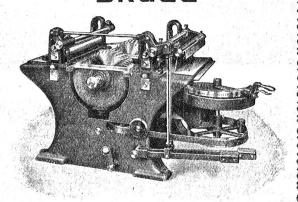
Doppelte Besäum- und Lattenkreissäge mit selbsttätigem Vorschub
