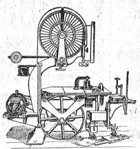
65, 70,80 cm Rollendurchmesser mit angebautem Elektromotor.
