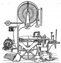
65, 70,80 cm Rollendurchmesser mit angebautem Elektromotor.
