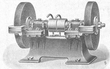
mit Ringschmier- oder Kugellagerung, in diversen Grössen,
