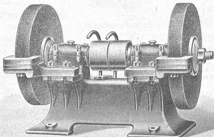
mit Ringschmierringlagerung, oder Kugellagerung, in diversen Grössen,
