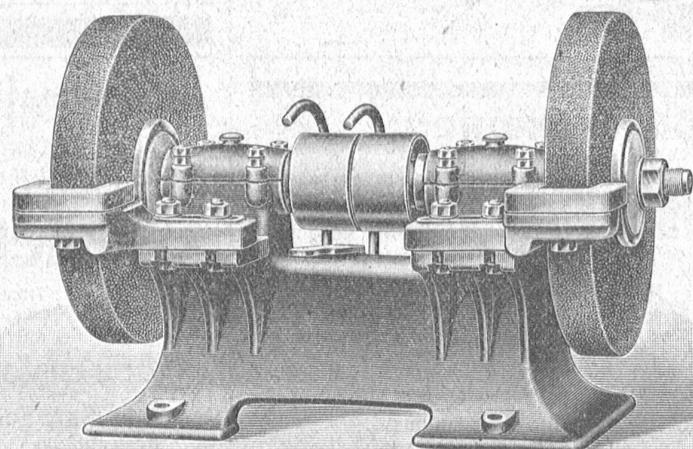
mit Ringschmier- oder Kugellagerung, in diversen Grössen,
