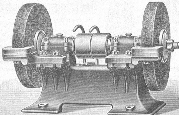
mit Ringschmier- oder Kugellagerung, in diversen Grössen,
