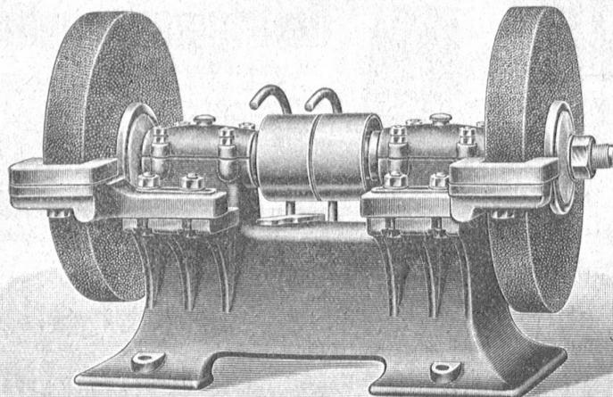
mit Ringschmier- oder Kugellagerung, in diversen Grössen,
