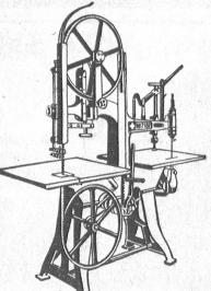
Bandsäge, Dekupiersäge Bohrmaschine
