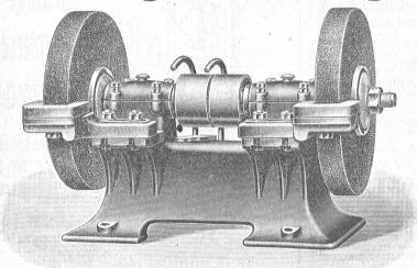
mit Ringschmier- oder Kugellagerung, in diversen Grössen,
