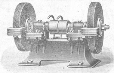
mit Ringschmier - oder Kugel lagerung, in diversen Grössen.
