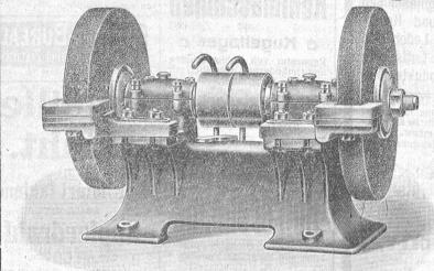
mit Ringschmier- oder Kugellagerung, in diversen Grössen,
