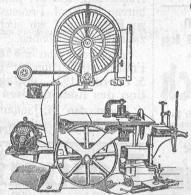
65, 70, 80 cm Rollendurchmesser mit angebautem Elektromotor. 192
