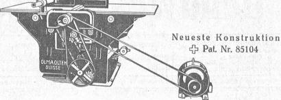
Komb. Abricht-Dickenhobelmaschinen mit 460 bis 610 mm Hobelbreite.
