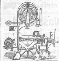
65, 70, 80 cm Rollendurchmesser mit angebautem Elektromotor. 348
