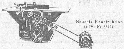
Komb. Abricht-Dickenhobelmaschinen mit 460 bis 610 mm Hobelbreite.
