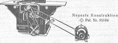
Komb. Abricht-Dickenhobelmaschinen mit 460 bis 610 mm Hobelbreite.
