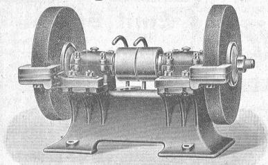
mit Ringschmier - oder Kugel lagerung, in diversen Grössen,
