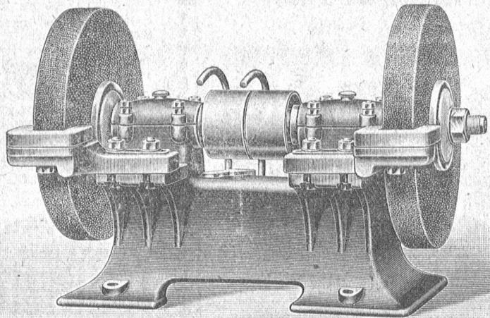
mit Ringschmier- oder Kugellagerung, in diversen Grössen,
