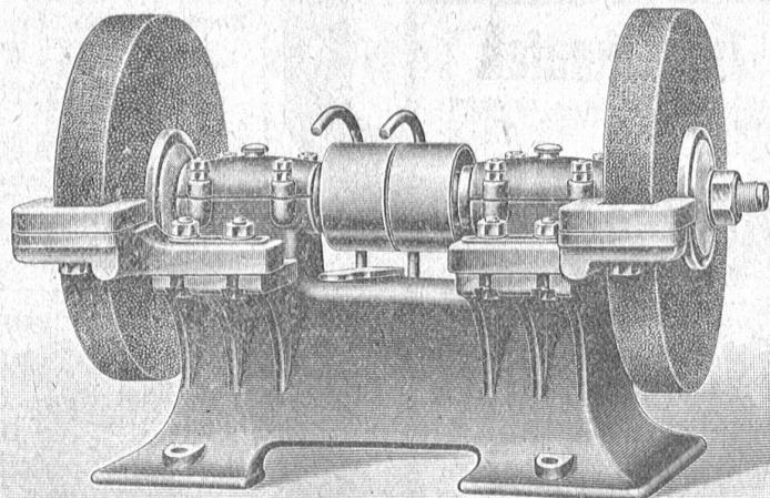
mit Ringschmier- oder Kugellagerung, in diversen Grössen,
