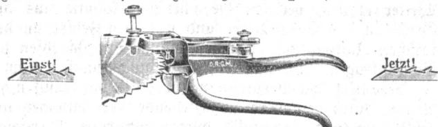
Der Blick ist von oben und wird jeder nächstfolgende Sägenzahn abwärts gedrückt, ohne daß mit der rechten Hand auf- oder abwärts eine Bewegung gemacht werden muß. Die Schrankweite des Sägenblattes ist an der Skalaschraube ersichtlich. Der Anschlag ist so zu stellen, daß der Sägenzahn von der Grundlinie aus glatt aufgedrückt wird, das macht den Zahn widerstandsfähig und verleiht den Sägen einen leichten Lauf und macht einen äußerst feinen sauberen Schnitt.
